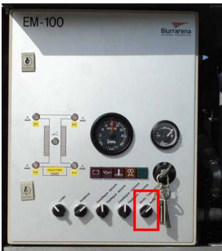
Una vez cumplidas estas condiciones seleccionaremos en el cuadro la posición de traslación (ver figura 5.9) y mediante el **mando control remoto** realizaremos el despliegue o repliegue del cilindro.
