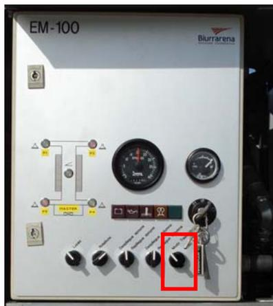
Una vez cumplidas estas condiciones seleccionaremos en el cuadro la posición de traslación (ver figura 5.8) y mediante el mando control remoto trasladaremos el equipo al lugar deseado.
