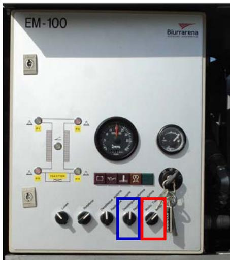
Una vez cumplidas estas condiciones seleccionaremos en el cuadro la posición de elevación (ver figura 5.10) y mediante el **interruptor** del cuadro eléctrico plegaremos o replegaremos la columna.
