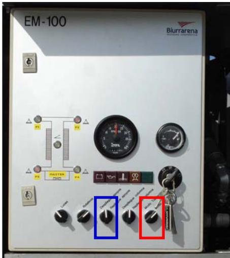
Una vez cumplidas estas condiciones seleccionaremos en el cuadro la posición de elevación (ver figura 5.10) y mediante el **interruptor** del cuadro eléctrico plegaremos o replegaremos los apoyos-patas.
