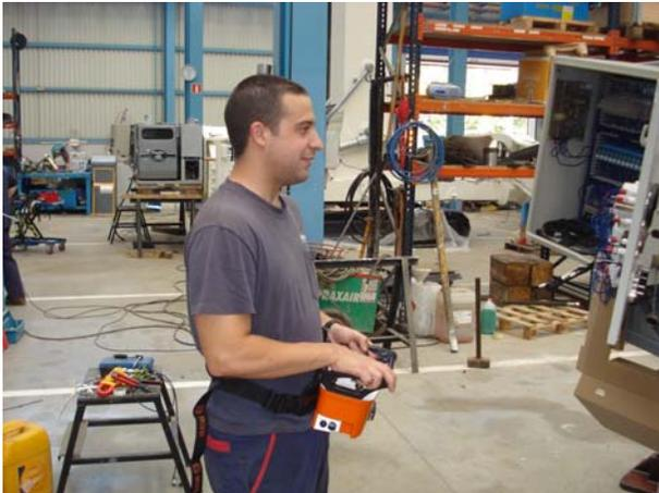
Figura n°6.6.-Colocación correcta mando radio-control
