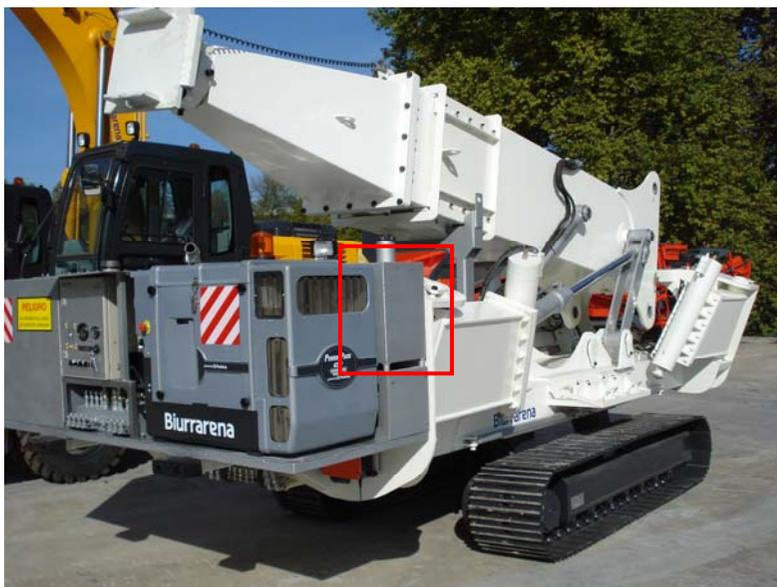
Figura nº4.11.- Depósito gasoil
