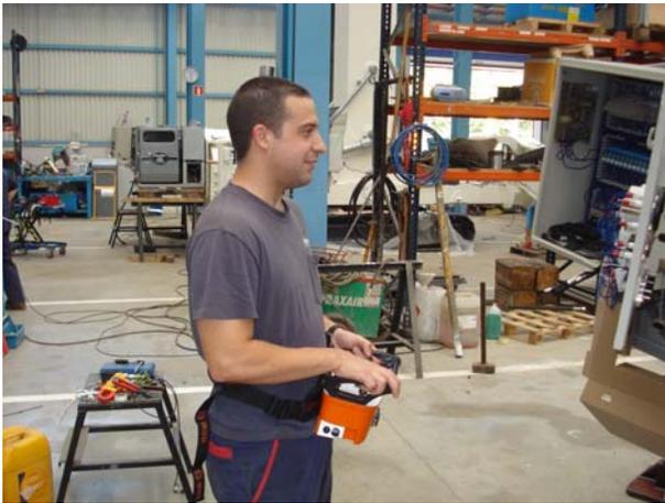
Figura nº6.11.-Colocación correcta mando radio-control
