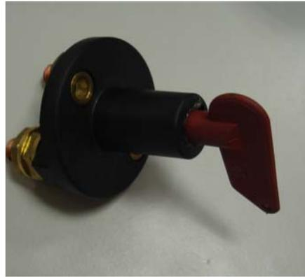
Figuras nº6.8.-Ubicación seccionador de baterías
