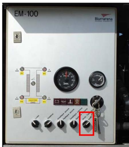
Figuras nº5.12.-Colocación barra seguridad e Interrup. selección traslación - elevación
