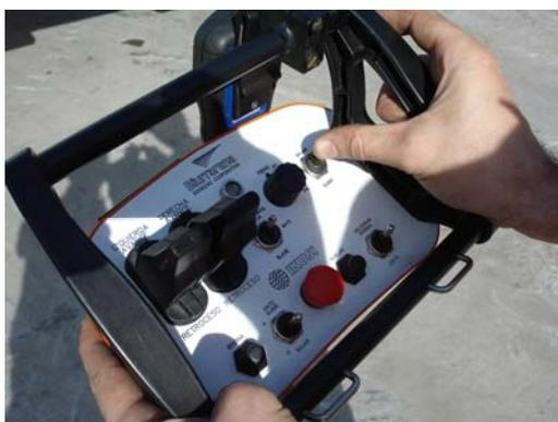
Una vez cumplidas estas condiciones seleccionaremos en el cuadro la posición de traslación (ver figura 5.12) y mediante **el mando control remoto** subiremos o bajaremos los cilindros. Asimismo, mediante un selector en el mando control remoto, se puede seleccionar hacerlo de una en una o todas las patas a la vez.
