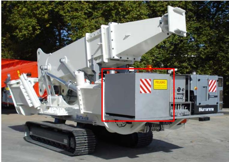
Figura nº4.10.- Depósito hidráulico
